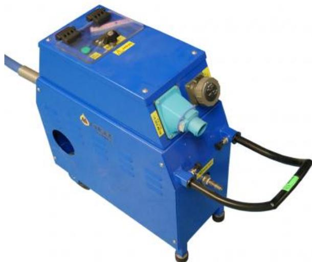
Dernier né de notre bureau d'étude le réchauffeur permet d'assurer une température d'air respirable « confortable » aux porteurs d'EPI (Masques à adduction d'air, tenues ou cagoules ventilées) lors d'opérations en conditions froides (par exemple démantèlement d'installations nucléaires à l'arrêt).
